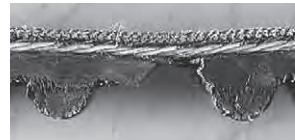
ローエッジVベルト コグ欠損
