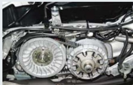
大型バイク等にも採用される、音が静かで変速がスムーズな“自動二輪車用変速ベルト”
