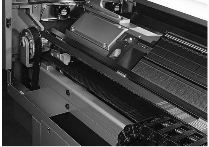
Große Stickmaschine (SUPER TORQUE Zahnriemen)
