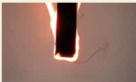
普通耐摩ベルト (ガスバーナを取り除いて5秒後)
