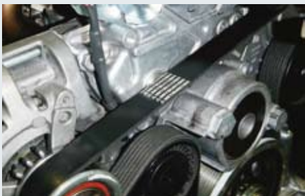
自動車のエアコン、オルタネータ等、多数の軸を1本で回す“自動車用Vリブドベルト”
