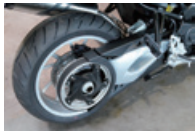
① 車両の電動化に対応し、環境にも貢献する二輪車向け「後輪駆動用ベルト」
