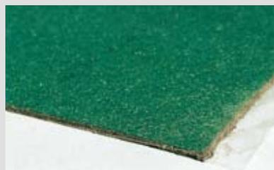
アクリル系樹脂を含浸させたポリエステルスパンボンド不織布に粘着層を積層しています。遮水シートと接着させますので強風による飛散、ズレの心配がありません。熱収縮によるシワの発生も緩和できます。
